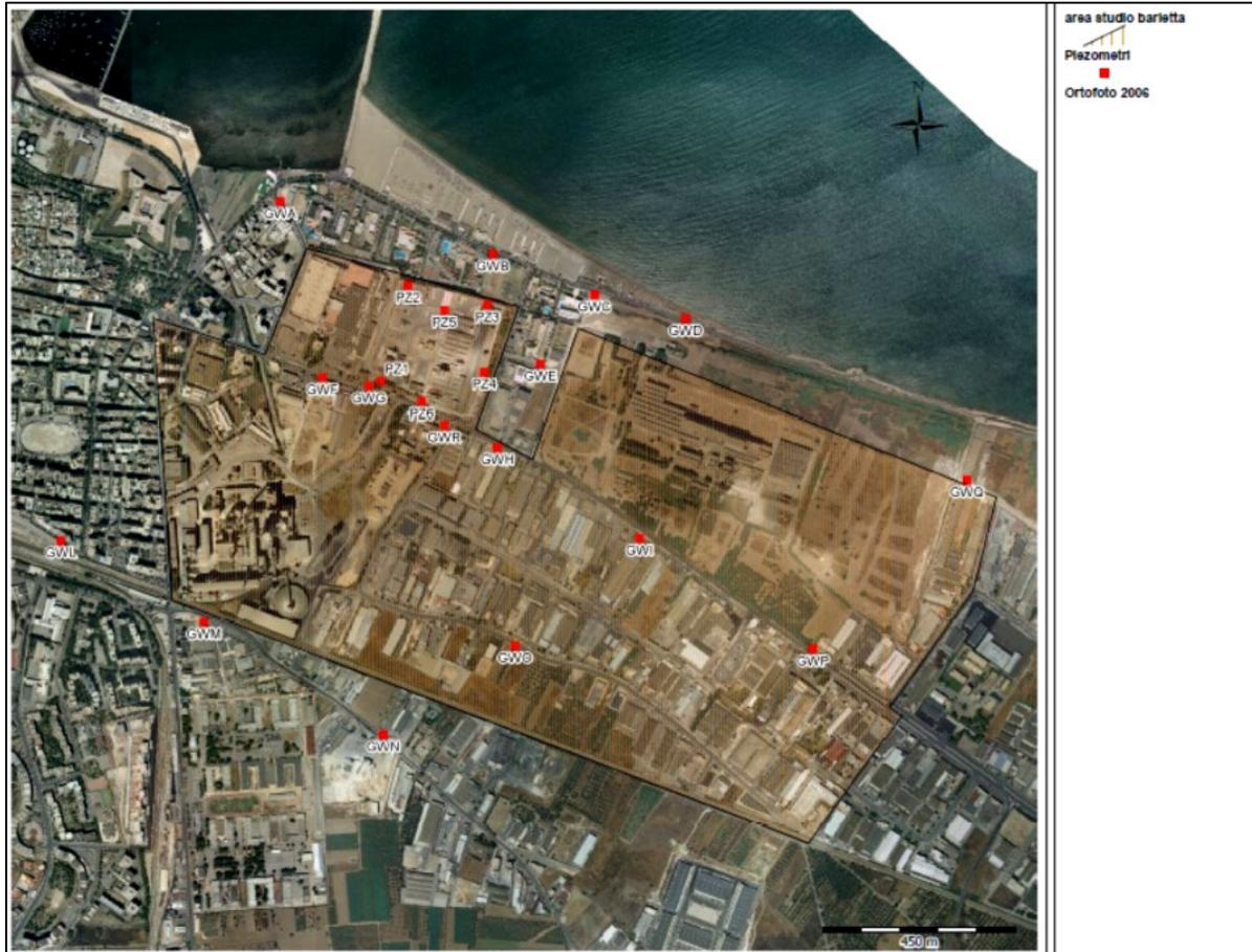
Figura 3 - Posizionamento piezometri campionati e area di studio
