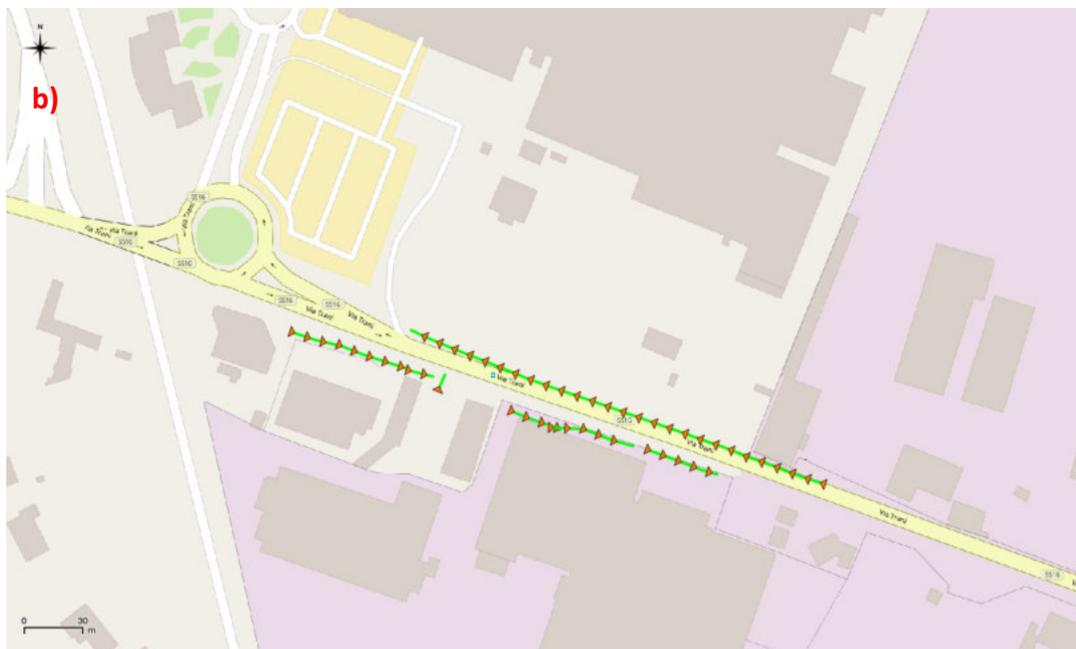
Figura 6: a) Tratto stradale lungo via Trani su cui è stata eseguita l'indagine geofisica; b) tracce di scansione con georadar.
