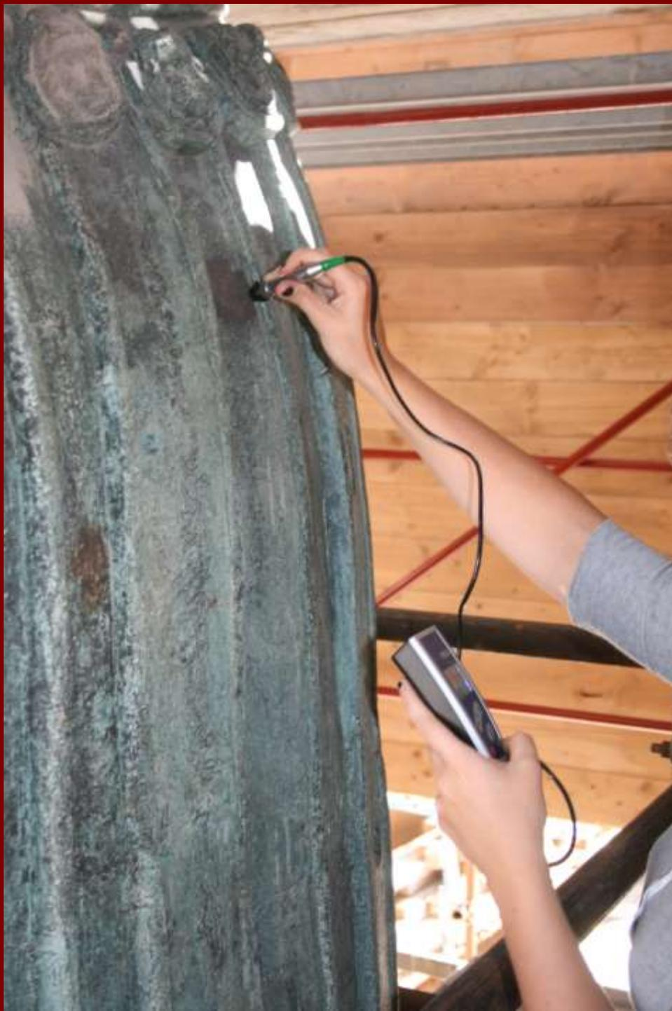
*misura velocità di corrosione*
