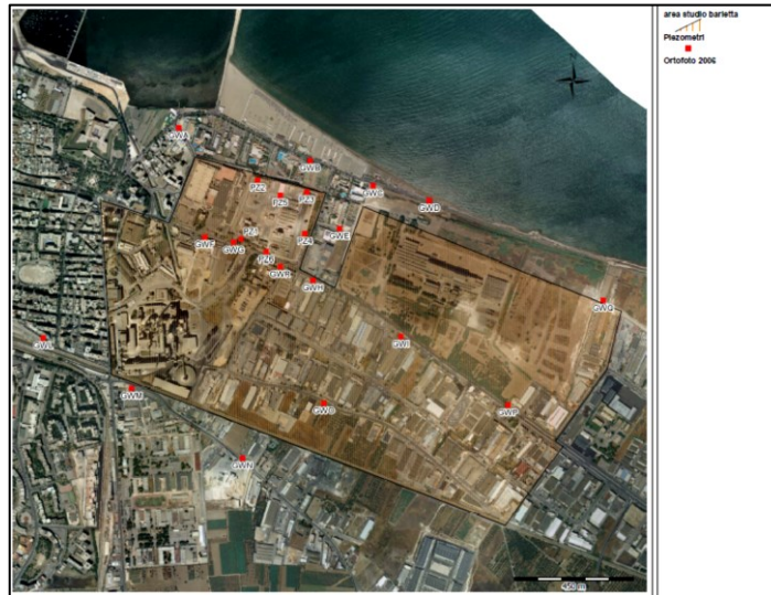
Fig. 2 - Posizionamento piezometri campionati e area di studio
