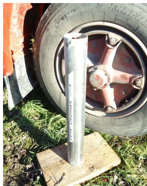
Foto 21. Prelievo del campione in fustella dal sondaggio P3
