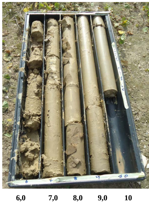
Foto 4 - Cassetta da 5,0 a 10,0 m del sondaggio S1
