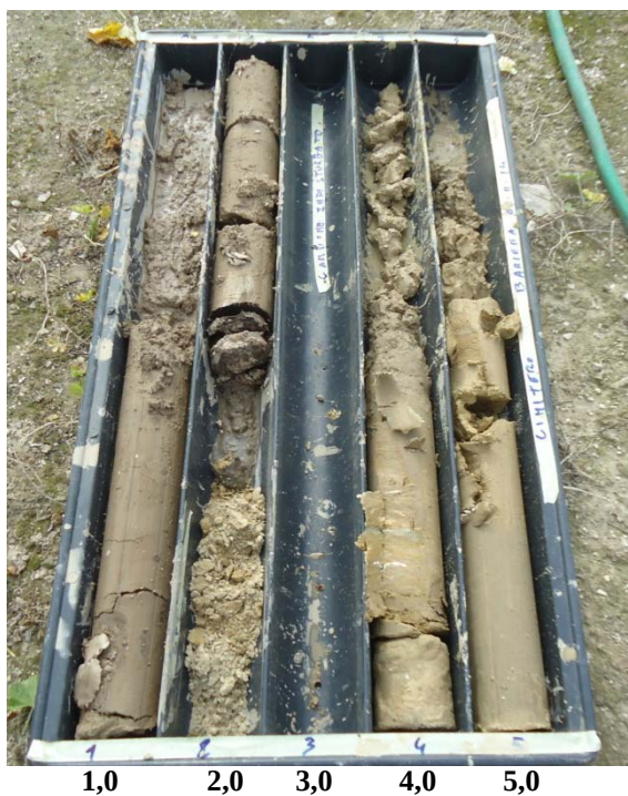
Foto 3 - Cassetta da 0,0 a 5,0 m del sondaggio S1
