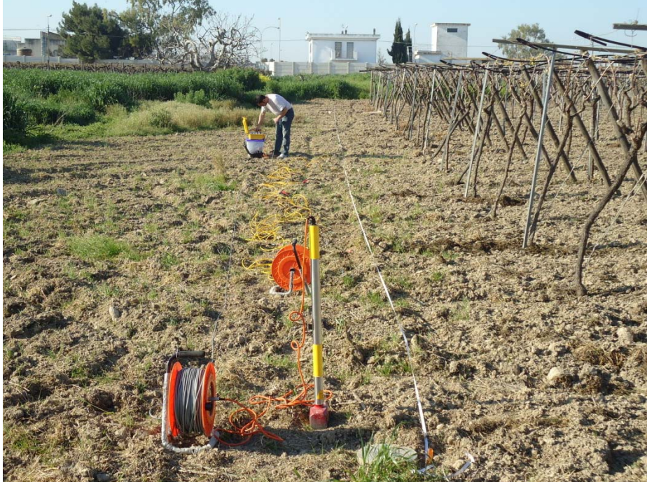
Foto 1. Stendimento sismico profilo MASW AB
