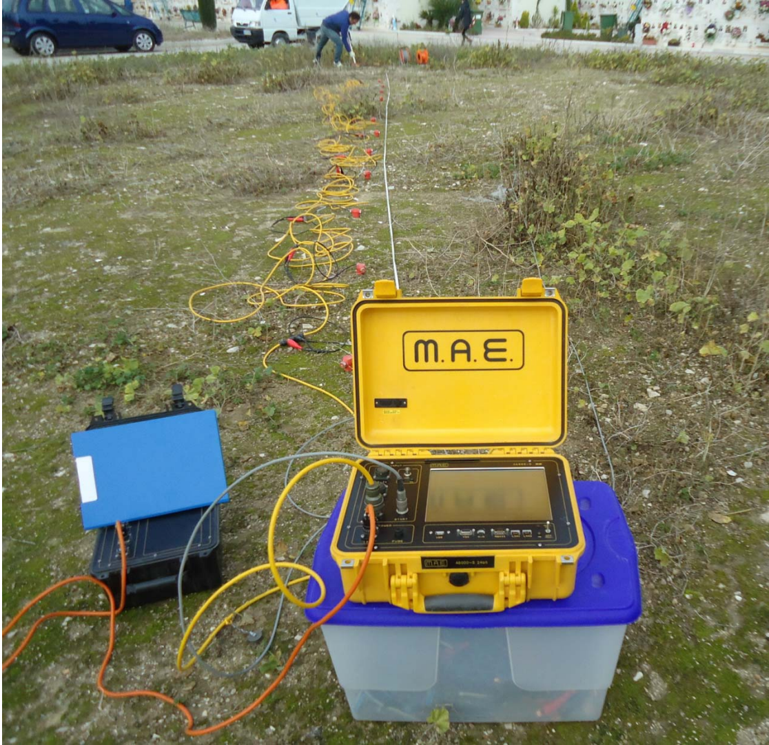
Foto 3. Stendimento sismico profilo MASW EF
