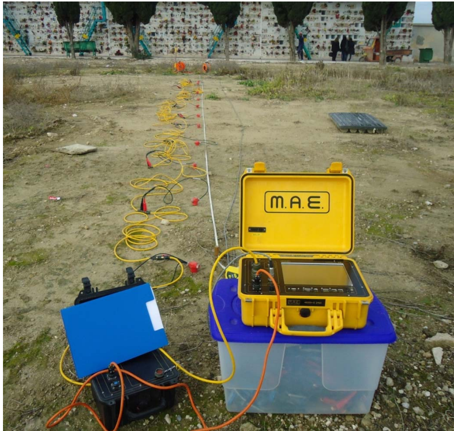
Foto 2. Stendimento sismico profilo MASW CD
