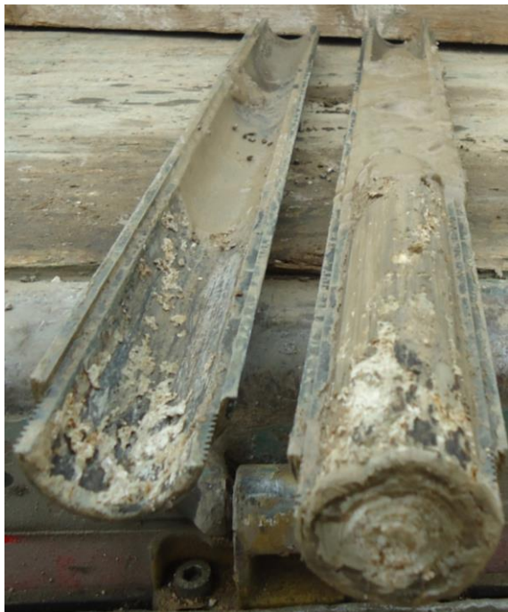
Foto 13 - Carota prova SPT S2 – profondità 4,5 m a 4,95 m
