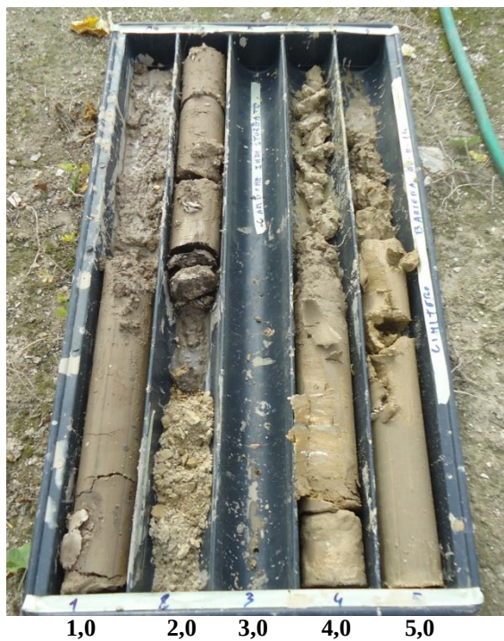
Foto 9 - Casseta da 0,0 a 5,0 m del sondaggio S1
