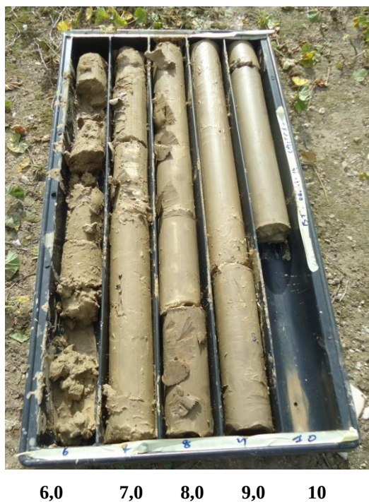
Foto 10 - Casseta da 5,0 a 10,0 m del sondaggio S1
