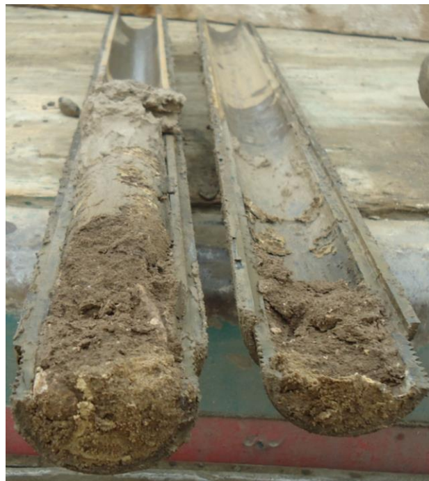
Foto 12 - Carota prova SPT S2 – profondità 1,0 m a 1,45 m
