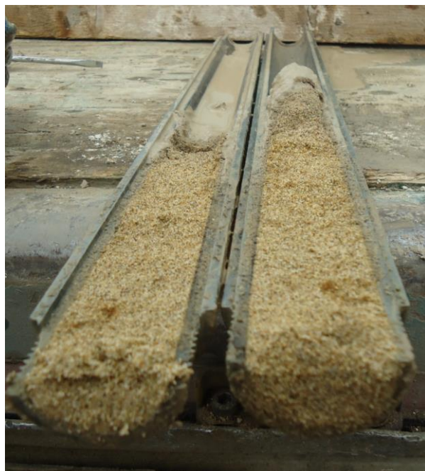
Foto 16 - Carota prova SPT S3 – profondità di campionamento 4,5 m a 4,95 m
