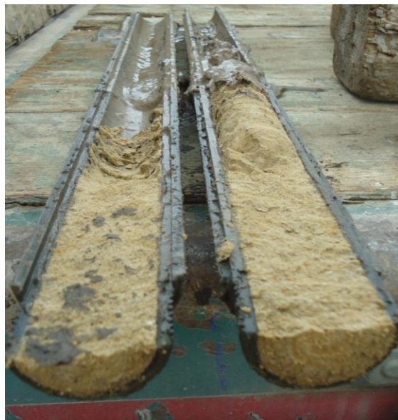
Foto 8 - Carota prova SPT S1 – profondità di campionamento 1,5 m a 1,95 m
