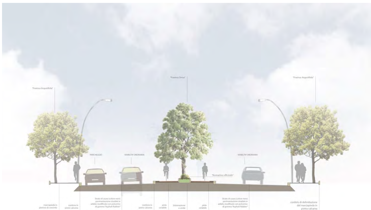
Nuova viabilità: sezione tipologica della sistemazione
