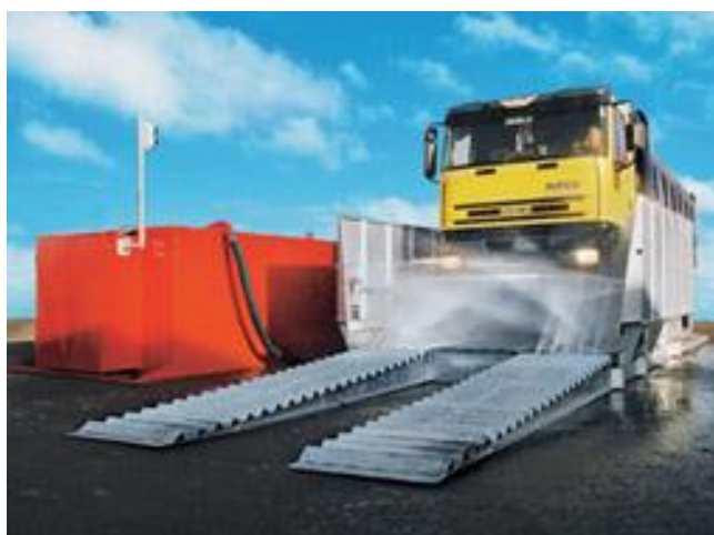
Figura 4: impianto mobile per il lavaggio ruote
