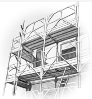
Ponteggio metallico fisso
