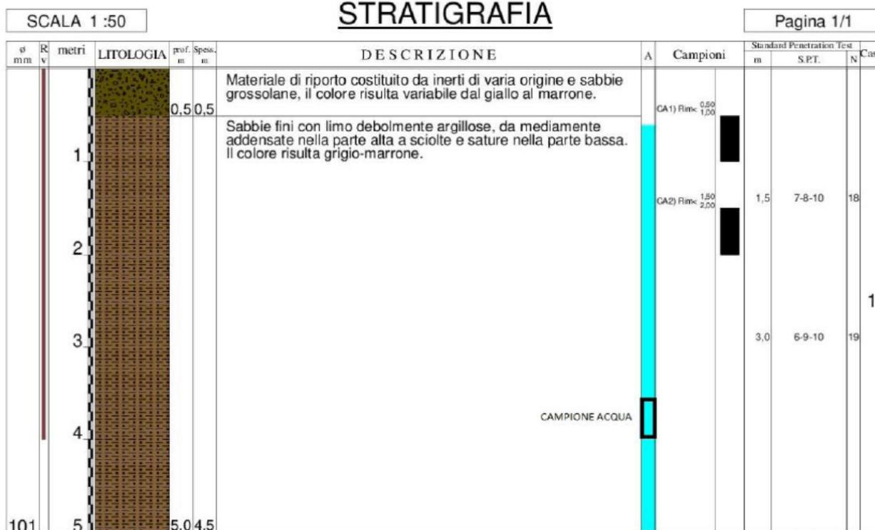
Fig.15: scheda di sondaggio relativa alla perforazione meccanica S3
