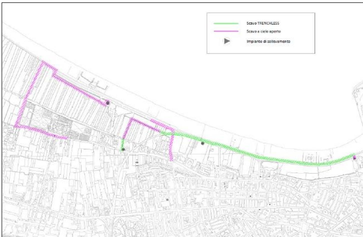
Fig.2: indicazione dei tratti che saranno realizzati con scavo a cielo aperto e con TOC
