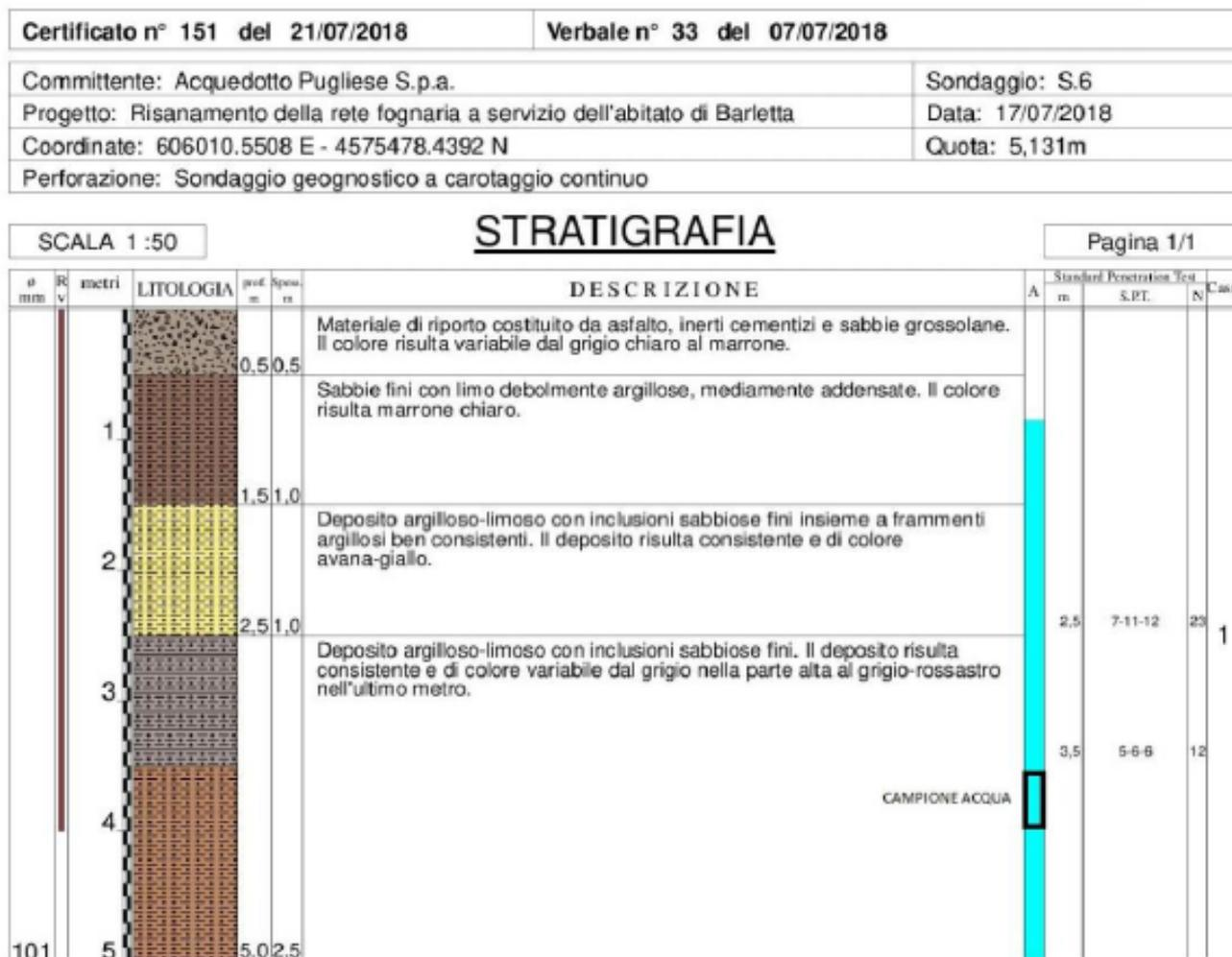
Fig.18: scheda di sondaggio relativa alla perforazione meccanica S6
