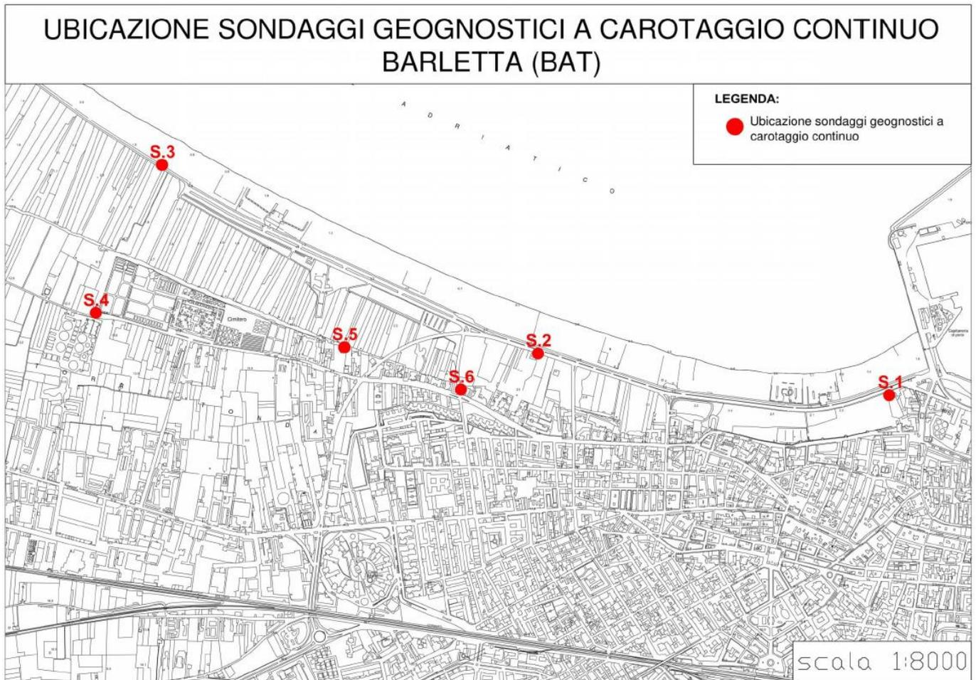
Fig.10: ubicazione dei fori di sondaggio eseguiti con la campagna geognostica del luglio 2018 nell'abitato
