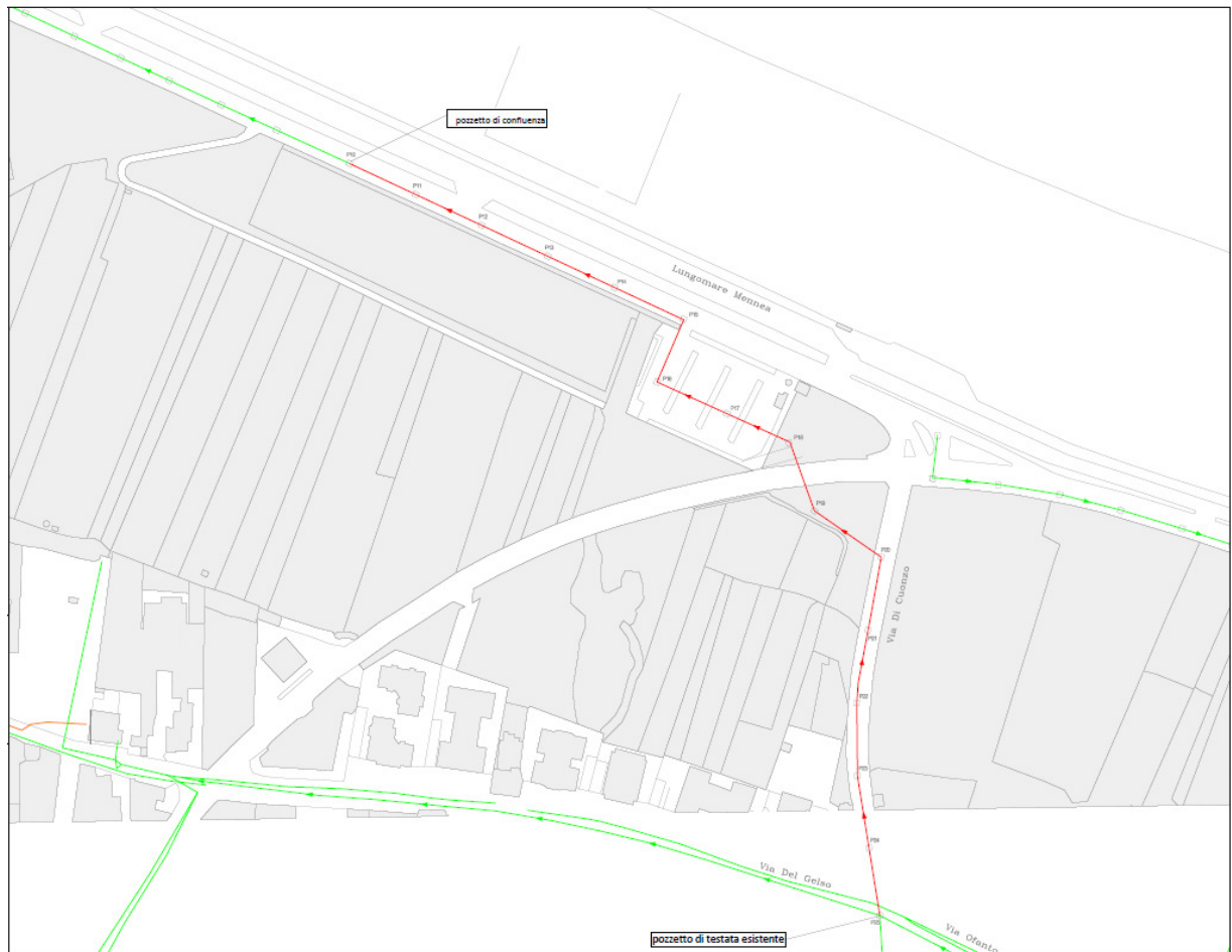
fig. 1 – Tracciato condotta a gravità INT.2
