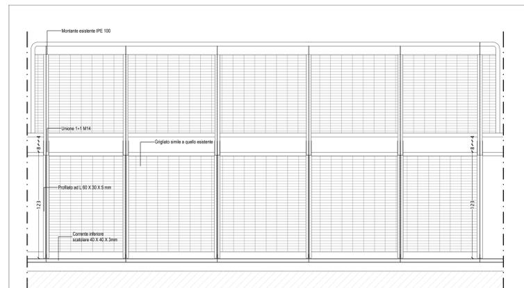
PARTICOLARE SEZIONE A - A' SEPARATORE SETTORI
