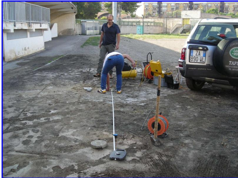
**Fig. 8 – Sorgente energizzate, costituita da massa battente su piastra di alluminio. Come starter/trigger è stato utilizzato un geofono verticale Geospace a 14Hz.**
