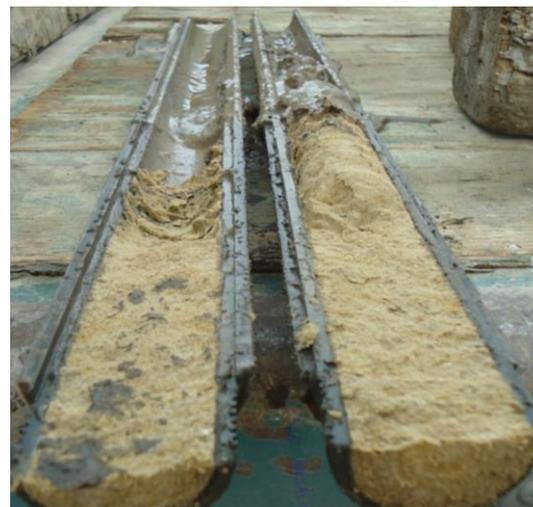
Foto 8 - Carota prova SPT S1 – profondità di campionamento 1,5 m a 1,95 m
