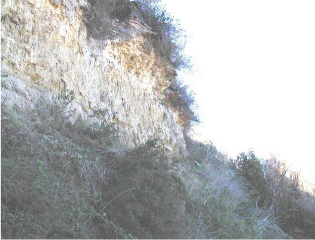
Foto 1 - Unità della scarpata naturale ed in particolare l'unità calcarenitico sabbiosa (Unità CS) al di sopra di quella limoso-argillosa (Unità LA) (Sezioni 1-6)
