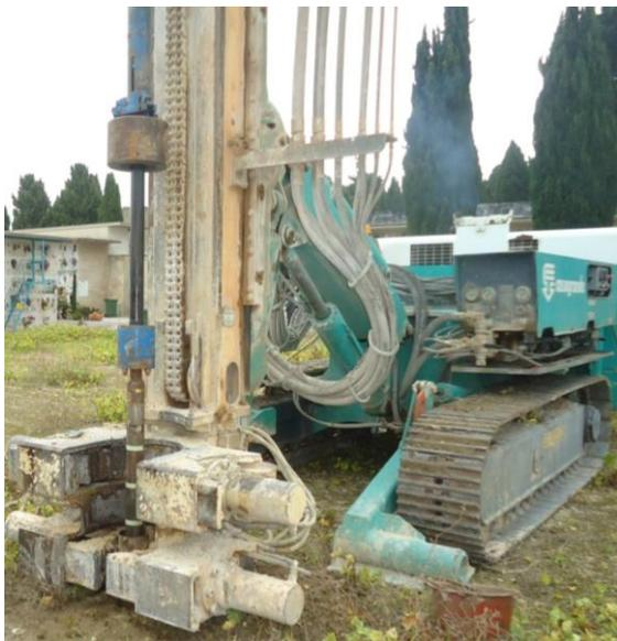
Foto 7- Ubicazione sondaggio S1 ed esecuzione prova SPT da 1,5 m a 1,95 m
