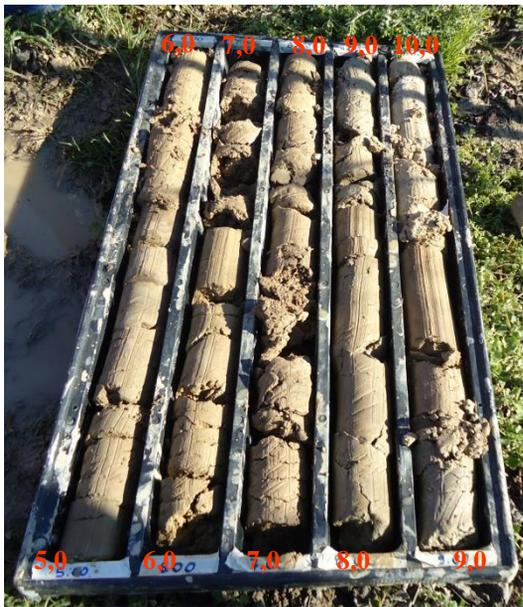
Foto 5 - Cassetta da 5,0 a 10,0 m del sondaggio P3
