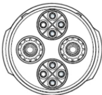
Il connettore standard per la ricarica veloce in corrente continua (DC).
