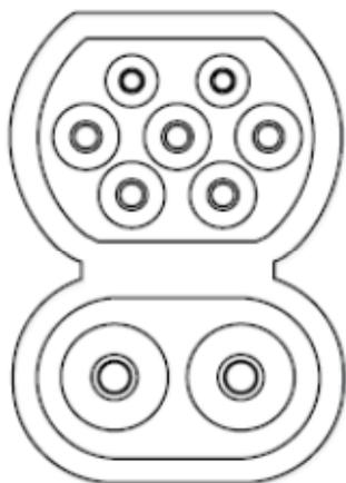
Lo standard CCS (Combined Charging System) consiste in un unico connettore di ricarica sul veicolo elettrico, che consente sia la ricarica rapida in corrente continua (DC) sia la ricarica lenta in corrente alternata (AC).
