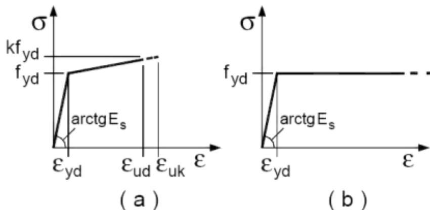
La resistenza di calcolo è data da  $f_{yk}/\gamma_f$ . Il coefficiente di sicurezza  $\gamma_f$  si assume pari a 1.15.
