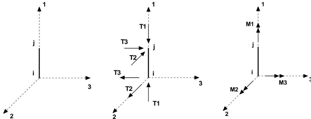
Definiti i e j come i due nodi iniziale e finale del pilastro, viene individuato un sistema di assi cartesiani 1-2-3 locale all'elemento, con origine nel Nodo i così composto:
