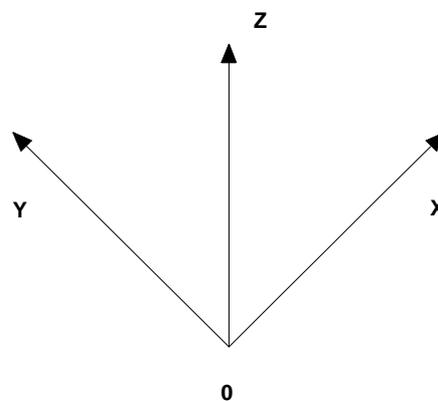
Il sistema di riferimento globale, rispetto al quale va riferita l'intera struttura, è costituito da una terna di assi cartesiani sinistrorsa  $O, X, Y, Z$  ( $X, Y$ , e  $Z$  sono disposti e orientati rispettivamente secondo il pollice, l'indice ed il medio della mano destra, una volta posizionati questi ultimi a  $90^\circ$  tra loro).
