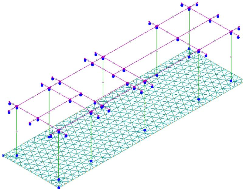
Dalle illustrazioni precedenti si evince come le aste, sia travi che pilastri, siano schematizzate con un tratto flessibile centrale e da due tratti (braccetti) rigidi alle estremità. I nodi vengono posizionati sull'asse verticale dei pilastri, in corrispondenza dell'estradosso della trave più alta che in esso si
