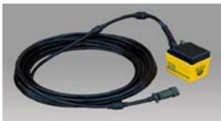
Figura 6-Strumentazione impiegata per la prospezione georadar.
