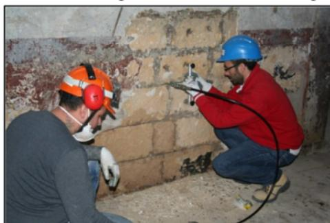
Figura 18- Esecuzione della prova con martinetto piatto
