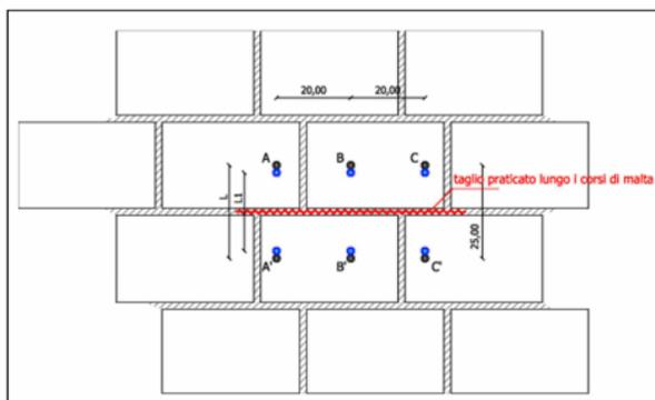
Figura 17-Prospetto muratura e schematizzazione dei capisaldi.
