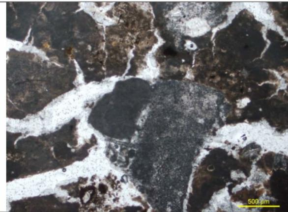
**Fig. 2-** Microfotografia al microscopio ottico a 2.5x e N//. In evidenza la presenza di litici calcarei.
