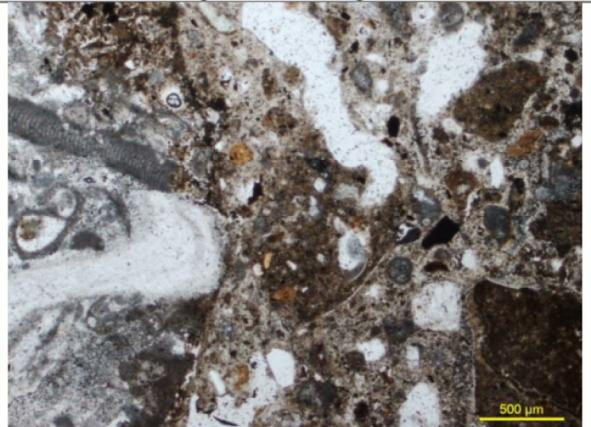
**Fig. 12-** Microfotografia al microscopio ottico a 2,5x e N//. In evidenza la classazione dell'aggregato e la porosità della malta.
