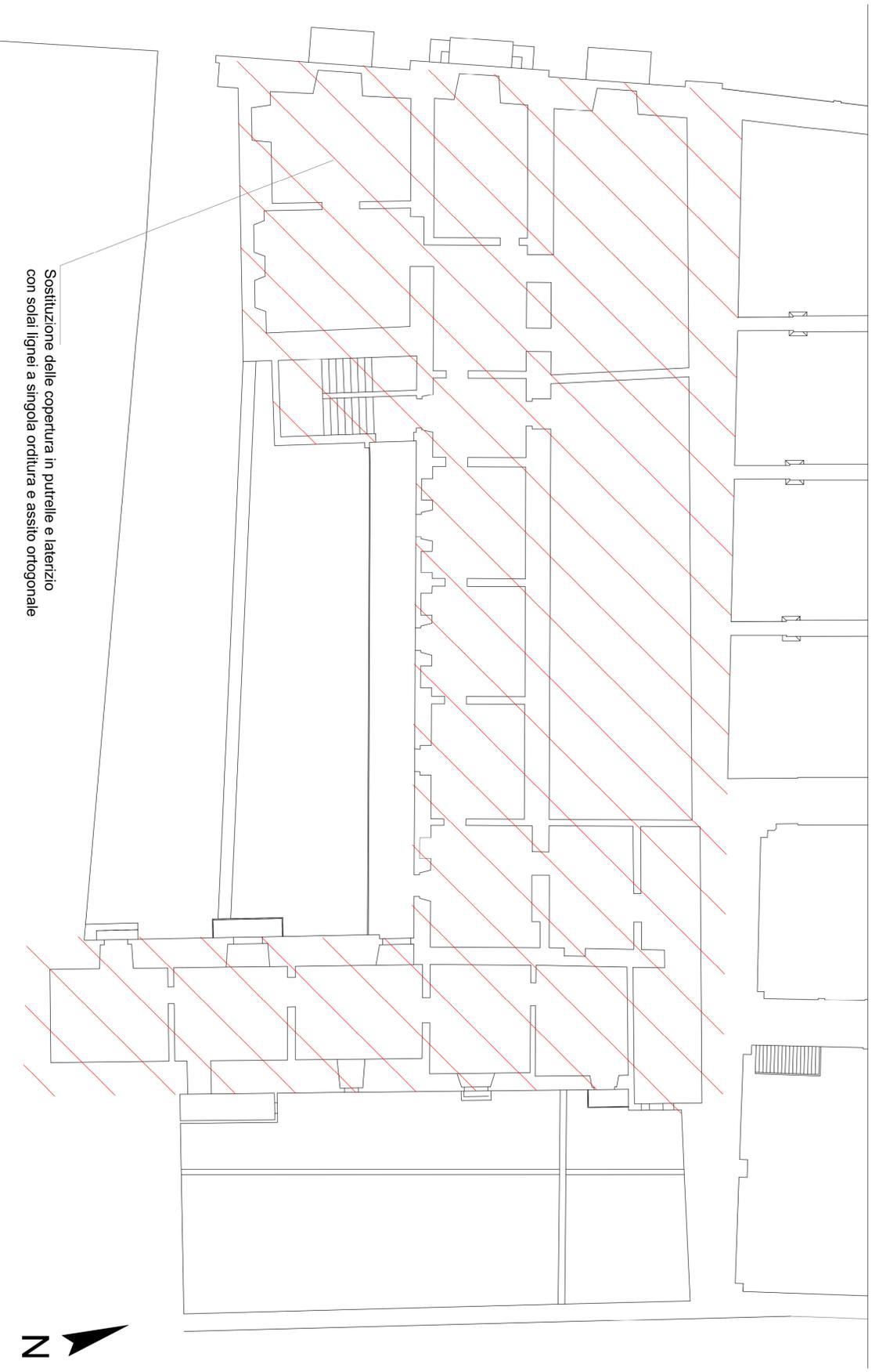
Sostituzione delle coperture in putrelle e laterizio
