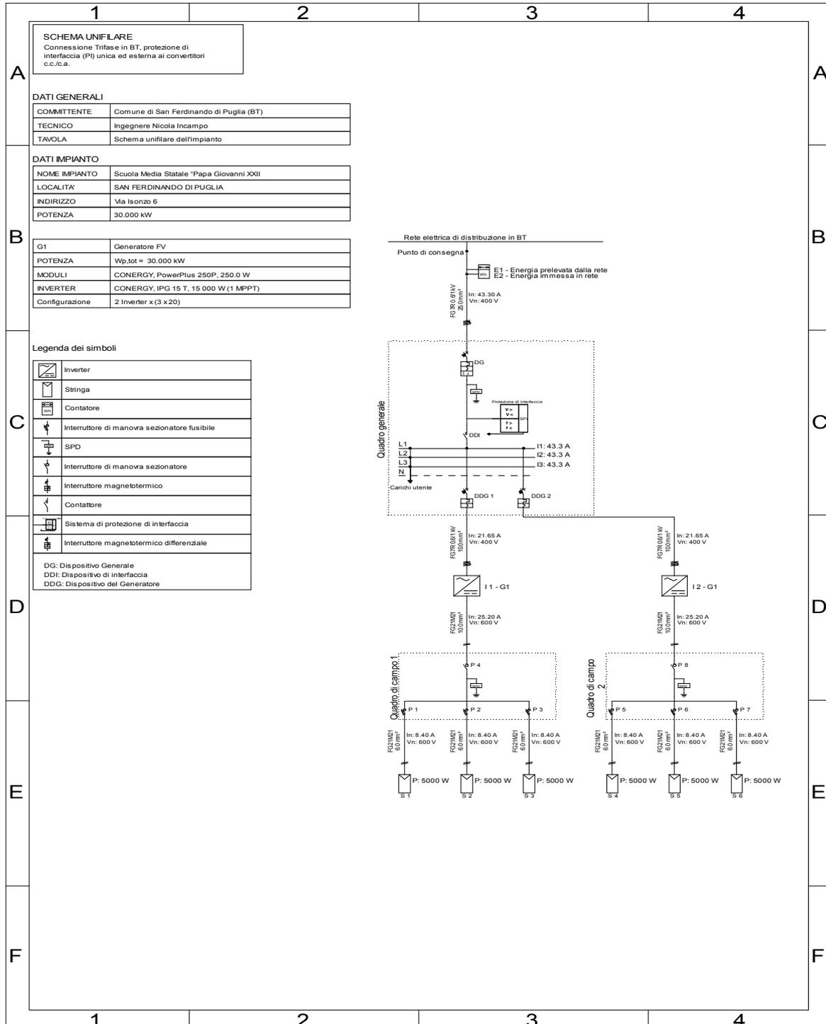
Fig. 8: Schema elettrico unifilare dell'impianto
