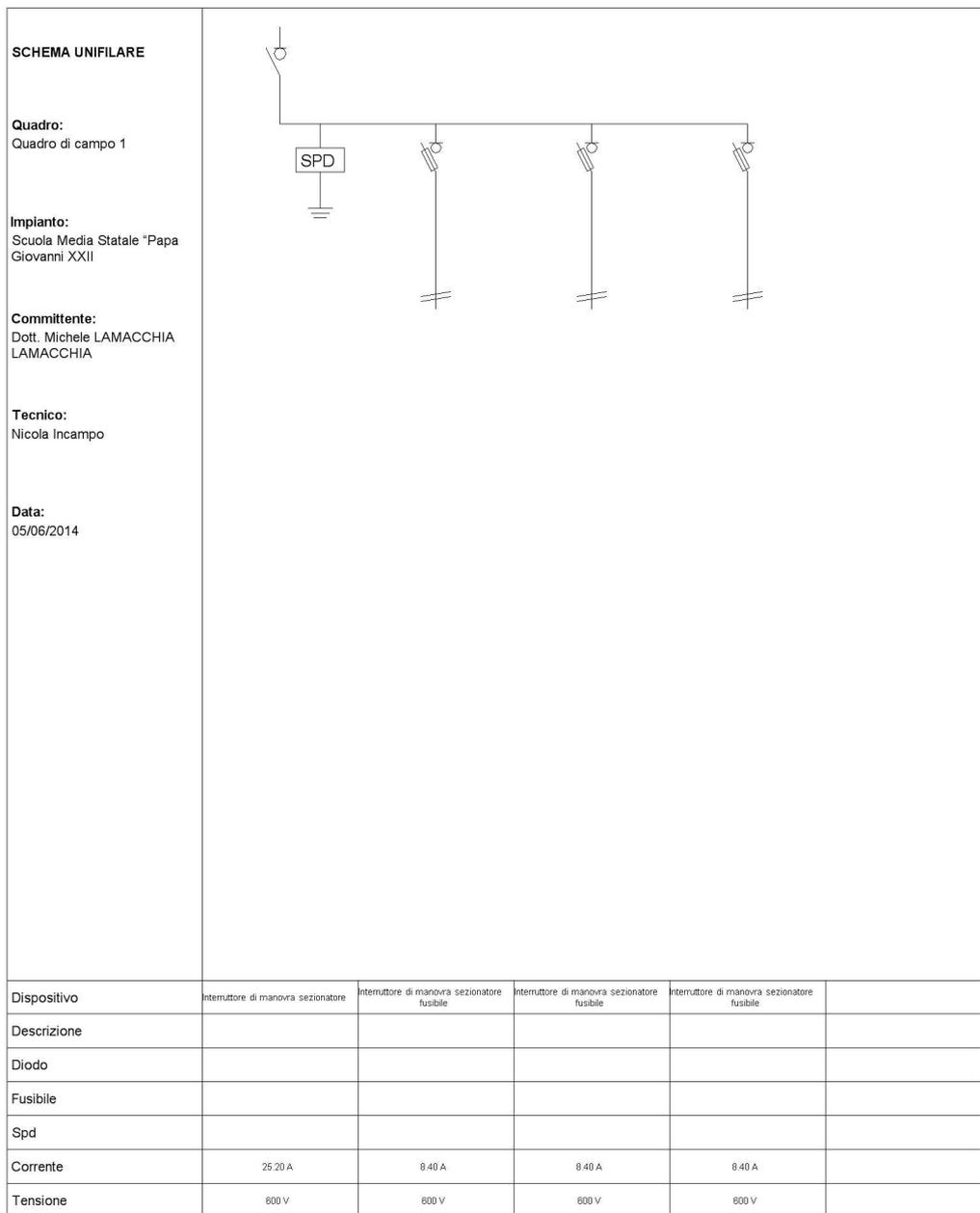
Fig. 6: Schema unifilare quadro "Quadro di campo 1"
